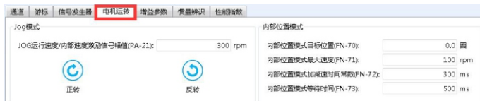
图 11-30 电机运行参数界面
