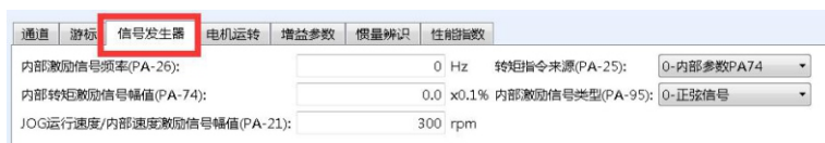
图 11- 29 信号发生器参数界面
